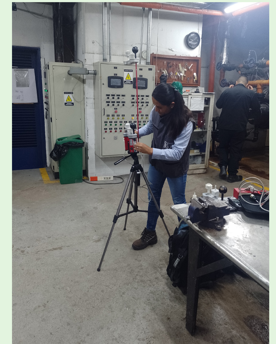
Imagen 5. Medición de Emisiones Atmosféricas Caldera #2. Fuente: Propia (2024)
