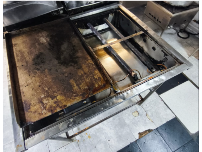
Imagen 17. Plancha de cocina con presencia de quemaduras.
