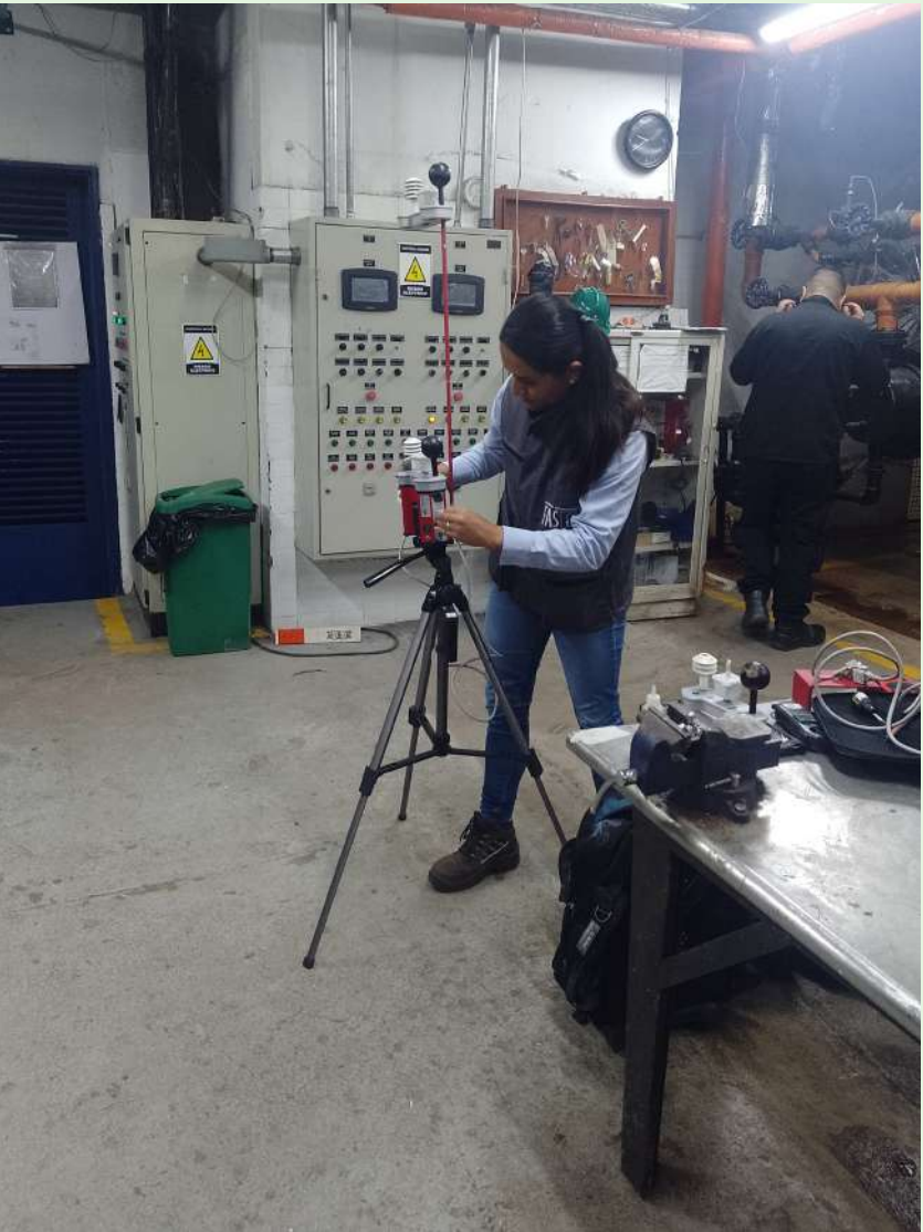
Imagen 5. Medición de Emisiones Atmosféricas Caldera #2. Fuente: Propia (2024)
