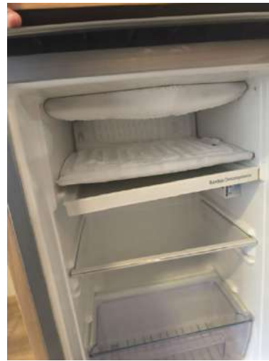
Imagen 24. Nevera cocina con escarcha y puerta de congelador rota.
